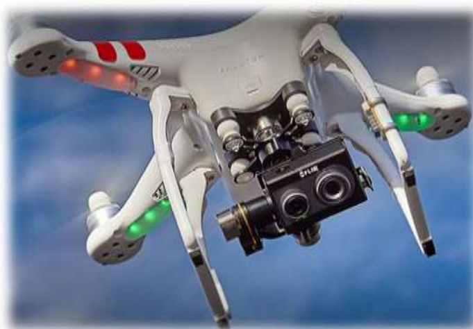
Figure 12. FLIR® Duo™ R Thermal Camera for sUAS
